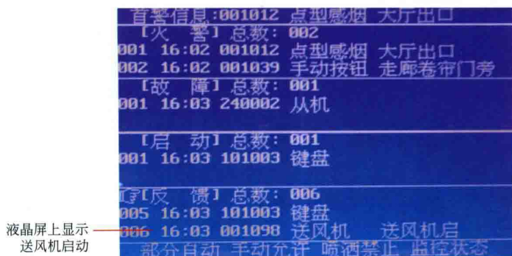
图9-70 液晶屏上显示送风机启动
