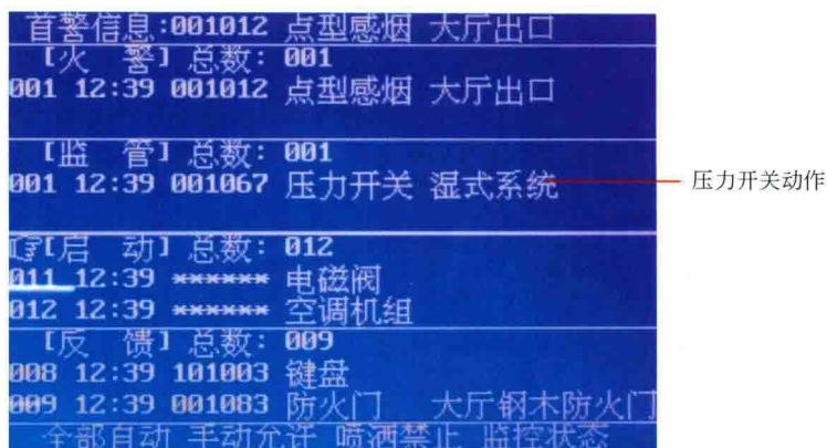
图10-26 控制器上液晶显示屏显示反馈信号
